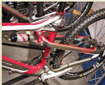
Vedle superlehkých karbonových hardtailů 4Ever přepracoval také celoodpružená modely řady SXC. Ty mají mobutnější profily trubek, 1,5" spodní ložisko hlavy, vnitřní vedení řadičích bowdenů či postmont úchyt zadní brzd. Nejvíce postavené modely sází také na integrovanou sedlovku.
