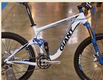
Vedle superlehkých karbonových hardtailů 4Ever přepracoval také celoodpružená modely řady SXC. Ty mají mobutnější profily trubek, 1,5" spodní ložisko hlavy, vnitřní vedení řadičích bowdenů či postmont úchyt zadní brzd. Nejvíce postavené modely sází také na integrovanou sedlovku.
